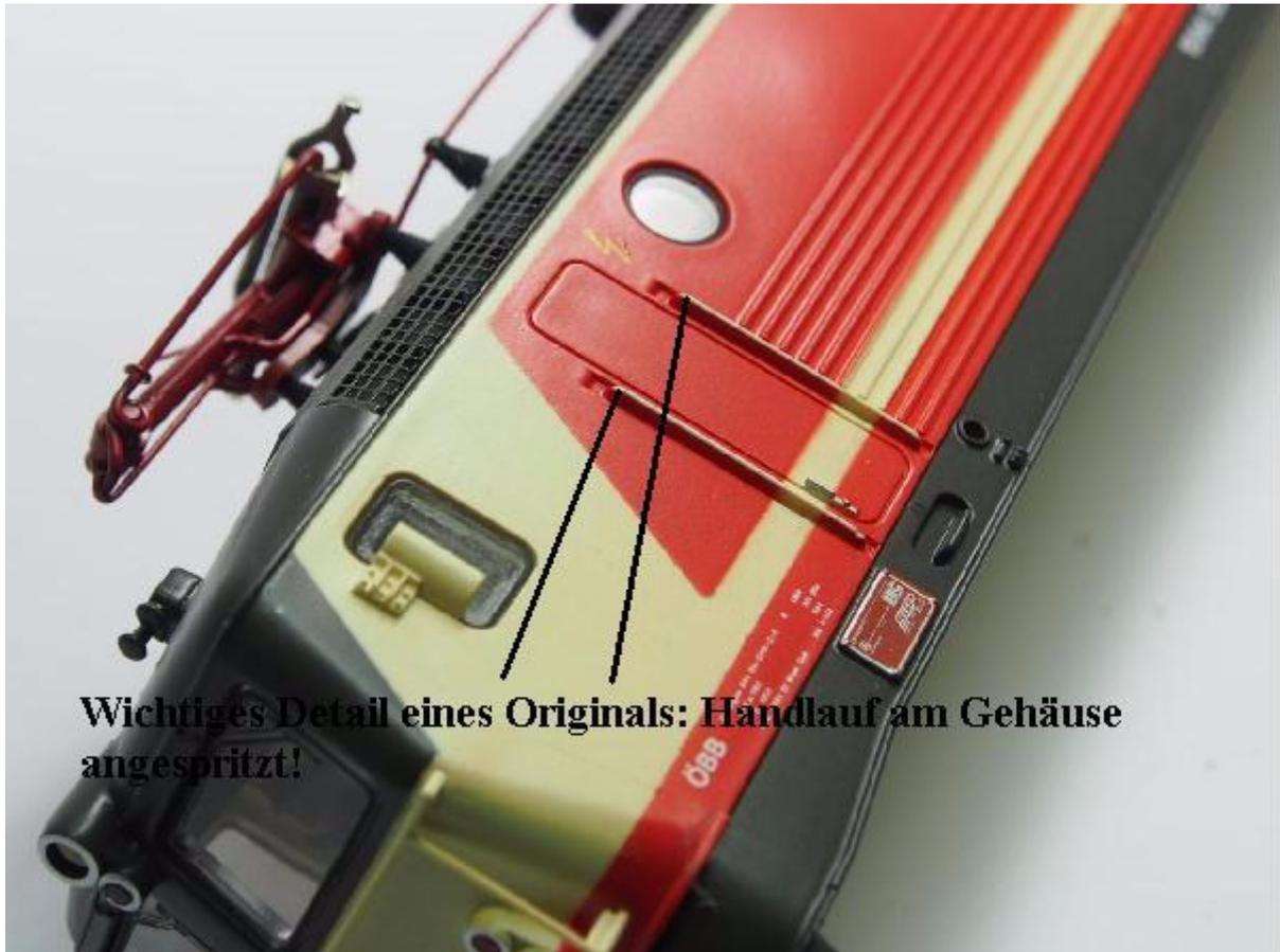
**Wichtiges Detail eines Originals: Handlauf am Gehäuse angespritzt!**
